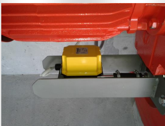
Števec obratov, ki omogoča nastavitve zgornje in spodnje končne lege ter vmesne lege.
